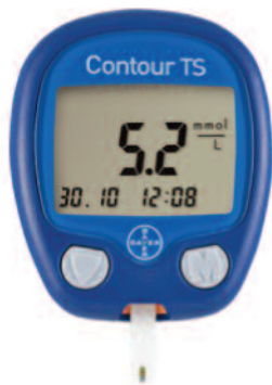
Рис. 3. Внешний вид глюкометра «Контур ТС» в момент измерения уровня глюкозы с помощью вставленной в оранжевый порт тест-полоски.
