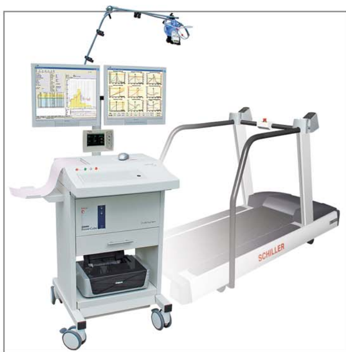
CS-200 Ergo-Spiro – система нагрузочного тестирования с газоанализом
